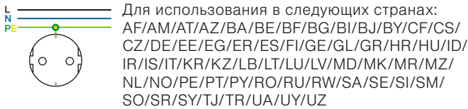
Рис. 1. Розетка SCHUKO* с 2 полюсами + заземление, 250 В ~ , 16 А
