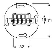
4 клеммы для подключения
