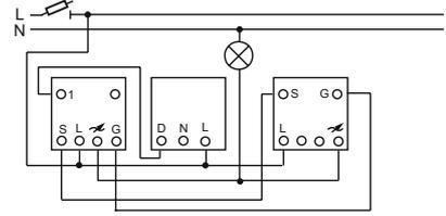
Универсальный поворотный светорегулятор 6591U с блоком управления 6292 U и усилителем мощности 6594 U
