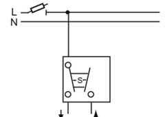
Выключатель жалюзи с фиксацией/ без фиксации, с блокировкой клавиш 2006/4 UC и 2026/4 UC
