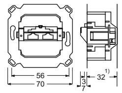
Розетки UAE, Кат.5+/Кат.6/Класс E, экранированные, RJ 45 клеммы LSA PLUS, 2 разьема 8/8 (8/8) полюсов 0217, 0218
