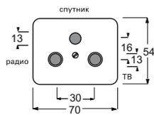
Центральная плата для антенной розетки радио/ ТВ/ спутник
